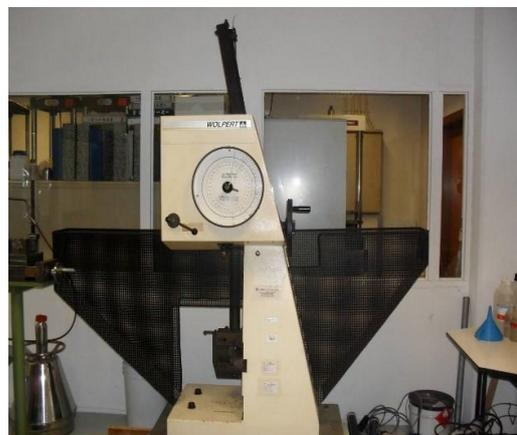
Figura11- Esempi di pendoli per prove d'urto; a) moderne apparecchiature informatiche, completamente chiuse per sicurezza; b) vecchie attrezzature manuali con protezione solo parziale.
