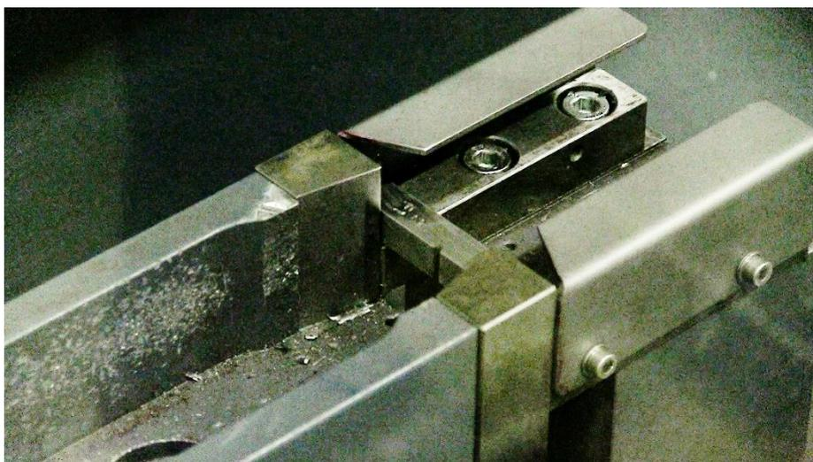
*Figura51- In alto: terminologia del provino che mostra la configurazione dei supporti del provino e delle incudini di una macchina per prove d'urto a pendolo; in basso: immagine delle incudini portanti con provino montato prima dell'impatto con il martello (la freccia bianca indica la direzione e il lato dell'impatto sul provino).*
